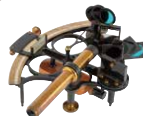
六分仪 于航海中测量天体的高度 原长冈高等工业学校
