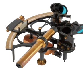
六分儀 航海中に天体の 高度を測定 (旧制長岡高等工業学校)
